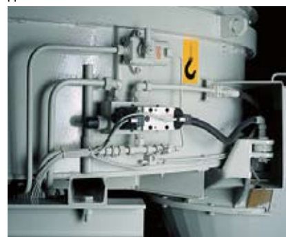
Ручное опорожнение в экстренной ситуации
