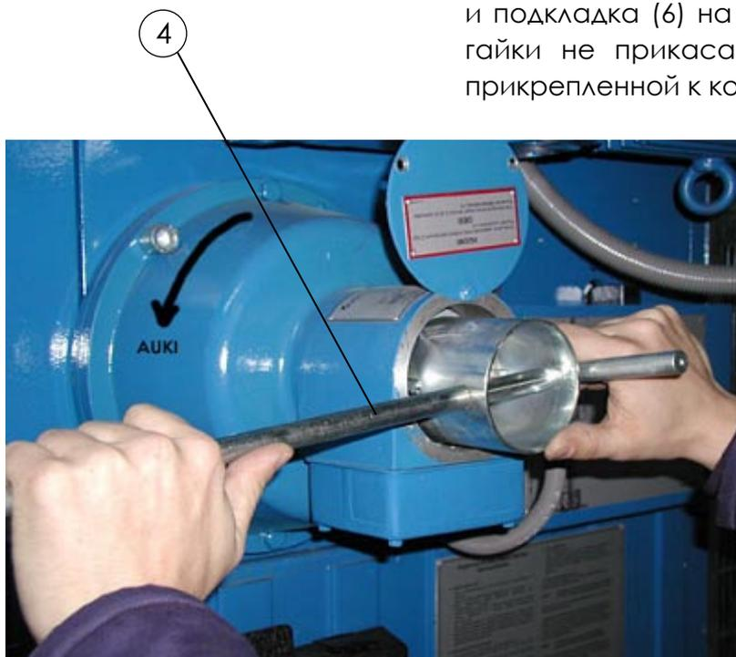
После этого поверните ключ еще немного назад (по часовой стрелке), чтобы стопорные винты (3) попали на место.
