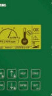
Особенно практичен в применении графический дисплей с четким текстовым меню. Модульная векторная система управления ориентирована на будущее и образует базу для дополнительных систем, имеющих новые функции.
