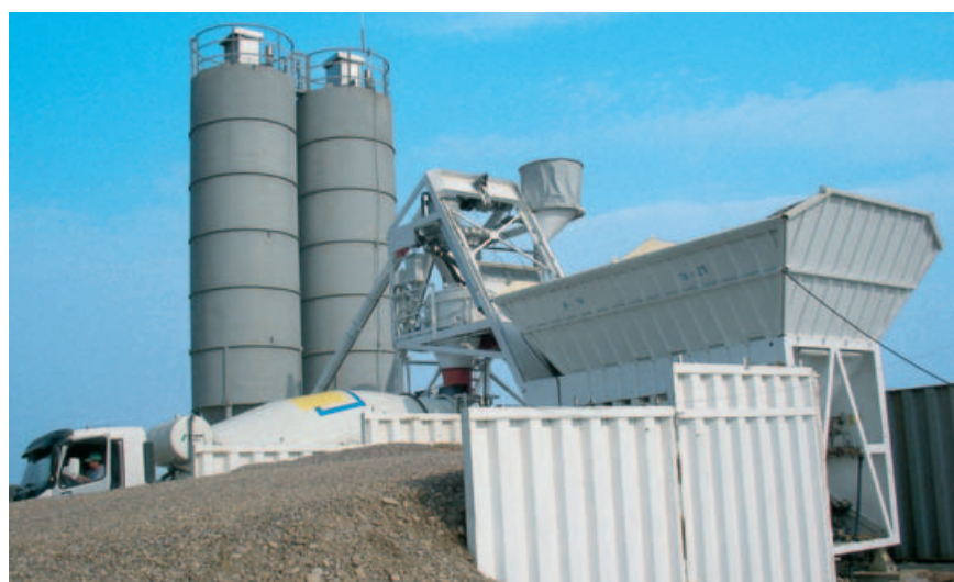
Бункер с 4 боксами, который может быть оснащен рампами с двух сторон. Плоский питатель служит при этом одновременно в качестве емкости весов.
