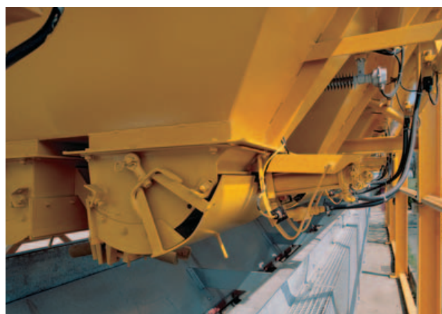
Дозирующий затвор и весовой конвейер для рядного бункера.
