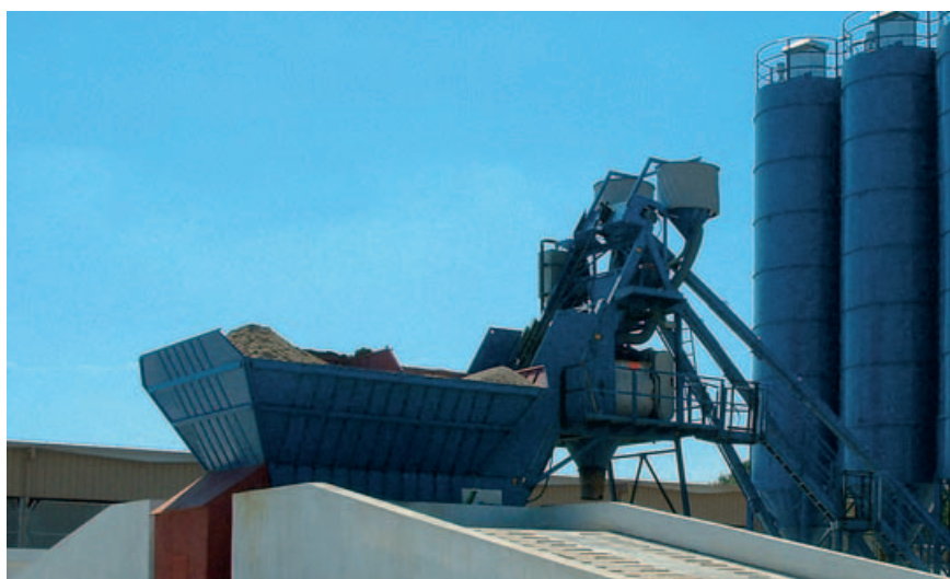
Бункер с 4 боксами, который может быть оснащен рампами с двух сторон. Плоский питатель служит при этом одновременно в качестве емкости весов.
