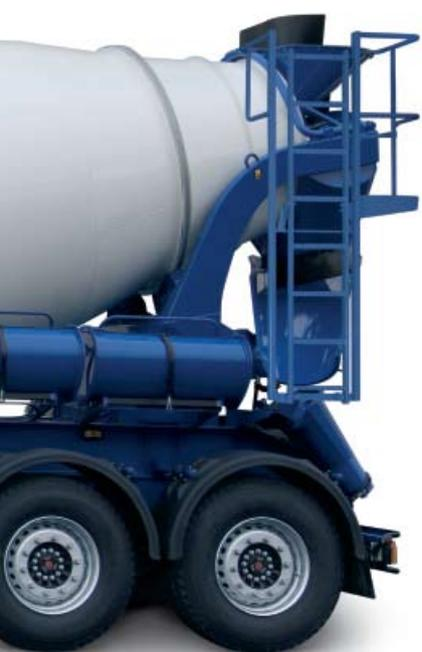
Конструкция автобетоносмесителя и седельного прицепа приведены в соответствие друг с другом и представляют в совокупности компактную единицу техники. Тем самым обеспечивается большой объем загрузки и высокие показатели полезной нагрузки, а также оптимальные показатели мобильности транспортного средства благодаря низкому центру тяжести.
