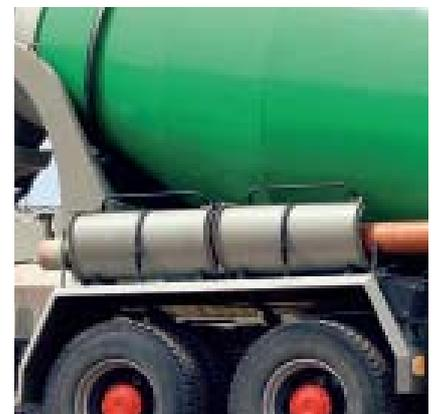
**Труба для прокачки бетона с кронштейном**
