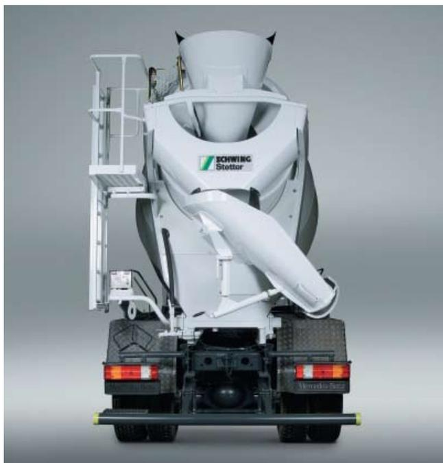
Откидной лоток длиной 1 450 мм позволяет легко выгружать бетон в приемную воронку бетононасоса.
