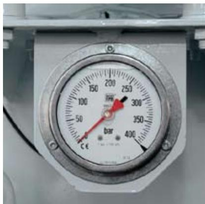
**Манометр консистенции бетона**
