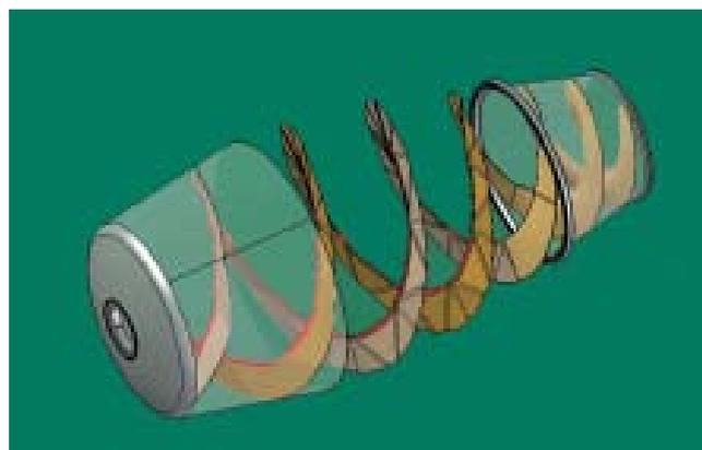
Новое расположение спиралей миксера служит для более длительного жизненного цикла машины даже при экстремальном воздействии.
