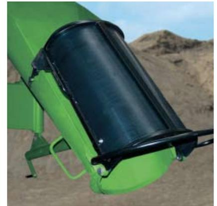
**Складной пластиковый желоб.** Желоб оснащен специальным хомутом для надежного складывания конструкции. Сама складная часть весит немного, чем облегчается процесс удлинения откидного лотка. Вы можете подсоединять до двух дополнительных пластиковых секций к лотку.
