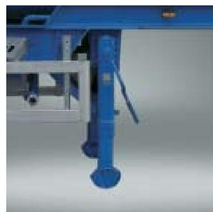
Функциональные дополнительные опорные колонны для поддержки после отсоединения от седельного тягача.
