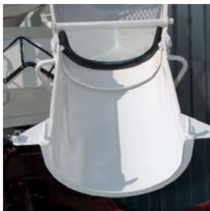
**Задняя крышка разгрузочного клапана – откидной лоток**
