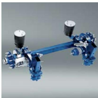
Оснащенные дисковой тормозной системой и системой одновременной блокировки ABS оси.
