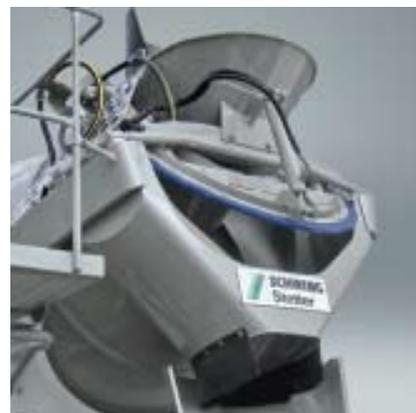
**Крышка для закрывания окна загрузочной воронки барабана 3/4**
