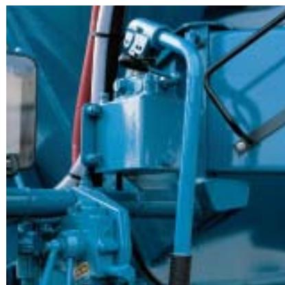
**Гидравлическое устройство для смены положения лотка**
