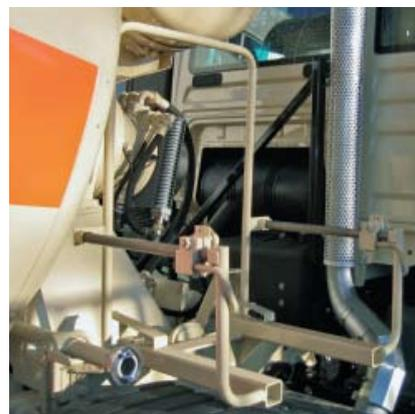
**Устройство для штабелирования емкостей для раствора.** Устройство для штабелирования емкостей для раствора, оснащенное быстро защелкивающимися зажимами.
