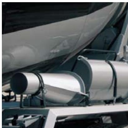
**Переходник для присоединения дополнительных бетоноводов.**
